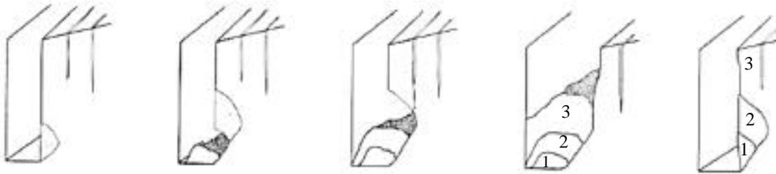
Mecánica de un derrumbe de la zanja:
