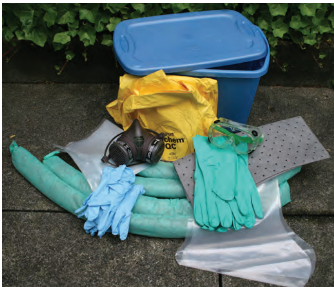
Equipo para limpiar derrames
